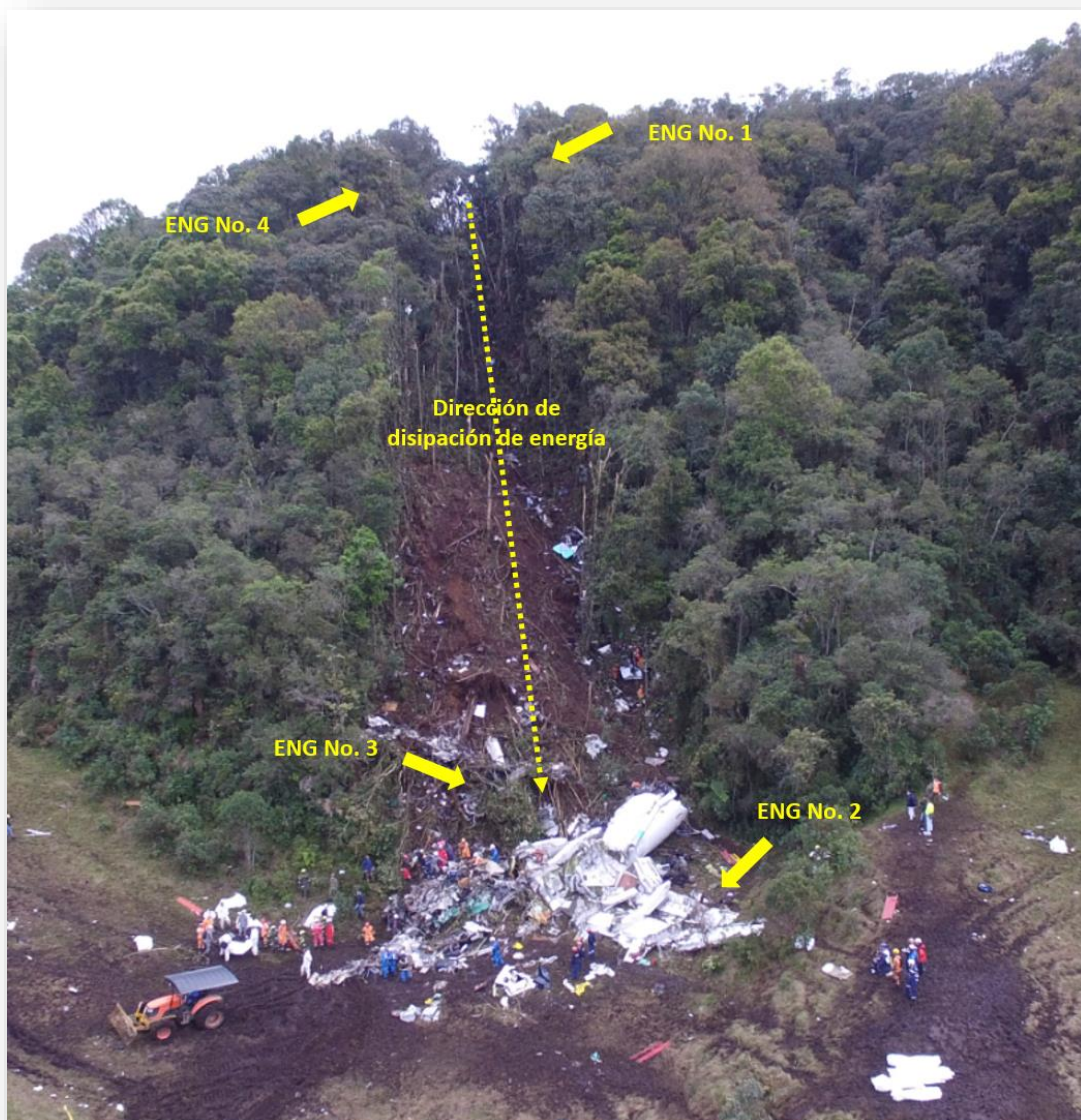
Figura 6. Posição dos motores no padrão dos destroços.
