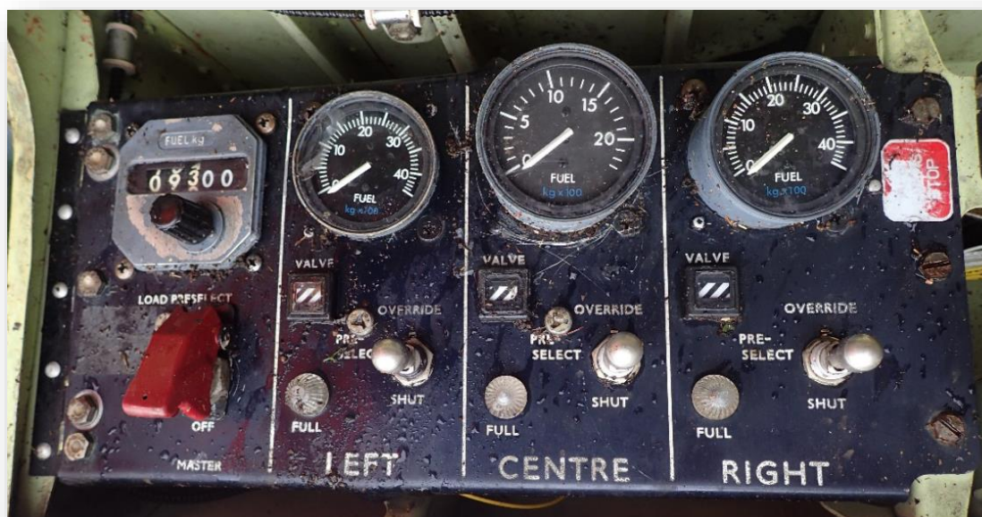
Figura 8 Painel de reabastecimento de combustível
